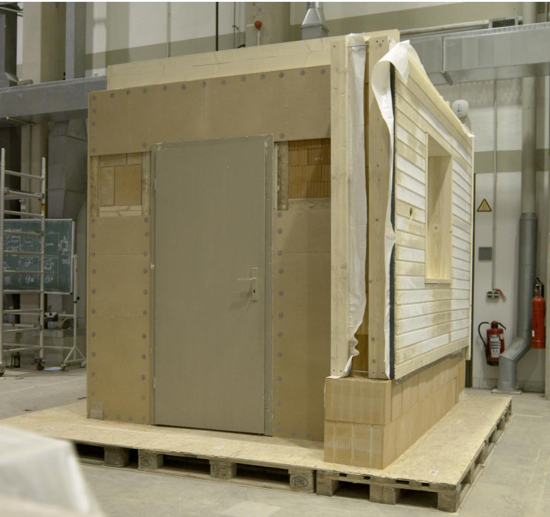
Das Forschungsprojekt „Ziegel Hybrid 4.0“ untersucht ressourceneffiziente Kombinationen von Ziegeln, Holz und Lehm bezüglich der kombinierten konstruktiven Ausführung in vorgefertigten Bauteilen. Das gemeinschaftlich von den Lehrstühlen Gebäudetechnologie und klimagerechtes Bauen, Holzbau und Baukonstruktion und Massivbau bearbeitete Forschungsprojekt bildet die Grundlage der Projektwoche „Ziegel Hybrid“ in der Design Factory 1:1 am Stammgelände der TUM.
