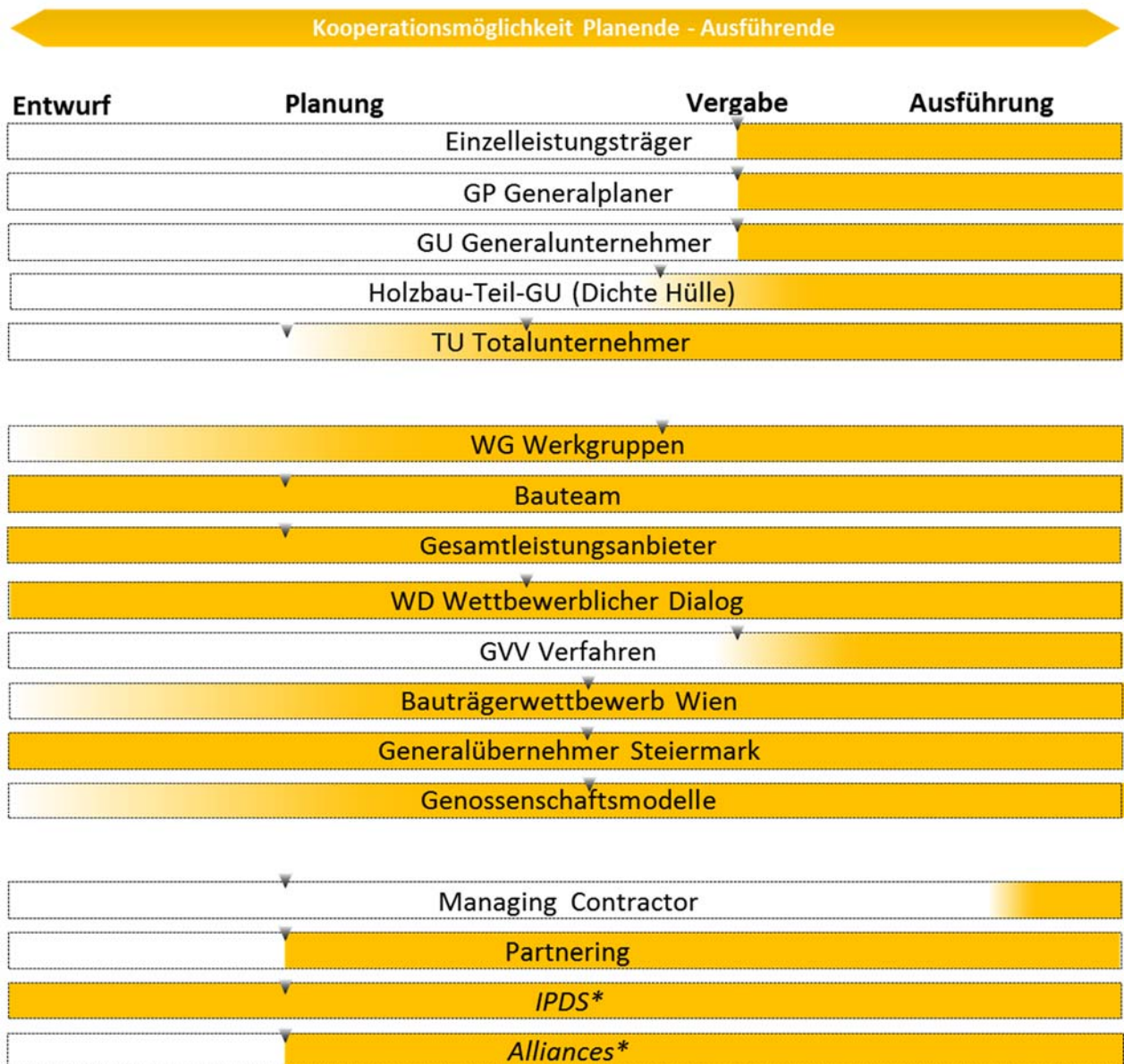
Abbildung 7: Möglichkeiten zur Kooperation in frühen Phasen (Entwurf).
